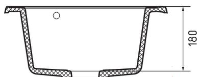
Общий размер  $\varnothing$  479 мм
