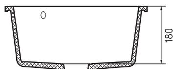
Общий размер  $\varnothing$  490 мм
